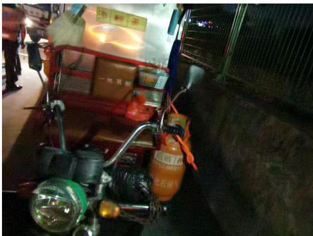
（三轮机动车上均载有液化气瓶，存在较大安全隐患）
