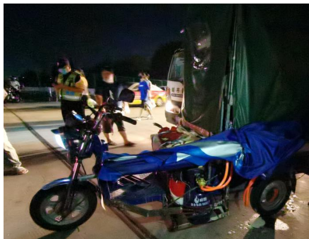
（三轮机动车上均载有液化气瓶，存在较大安全隐患）
