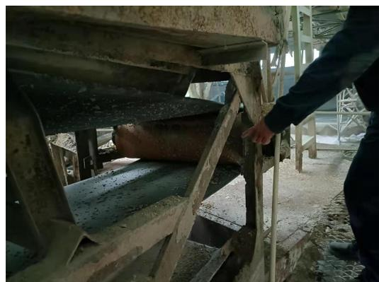
（左图为事故现场输送带概貌，右图为农日边左手臂被卷入输送带尾部滚轴位置）
