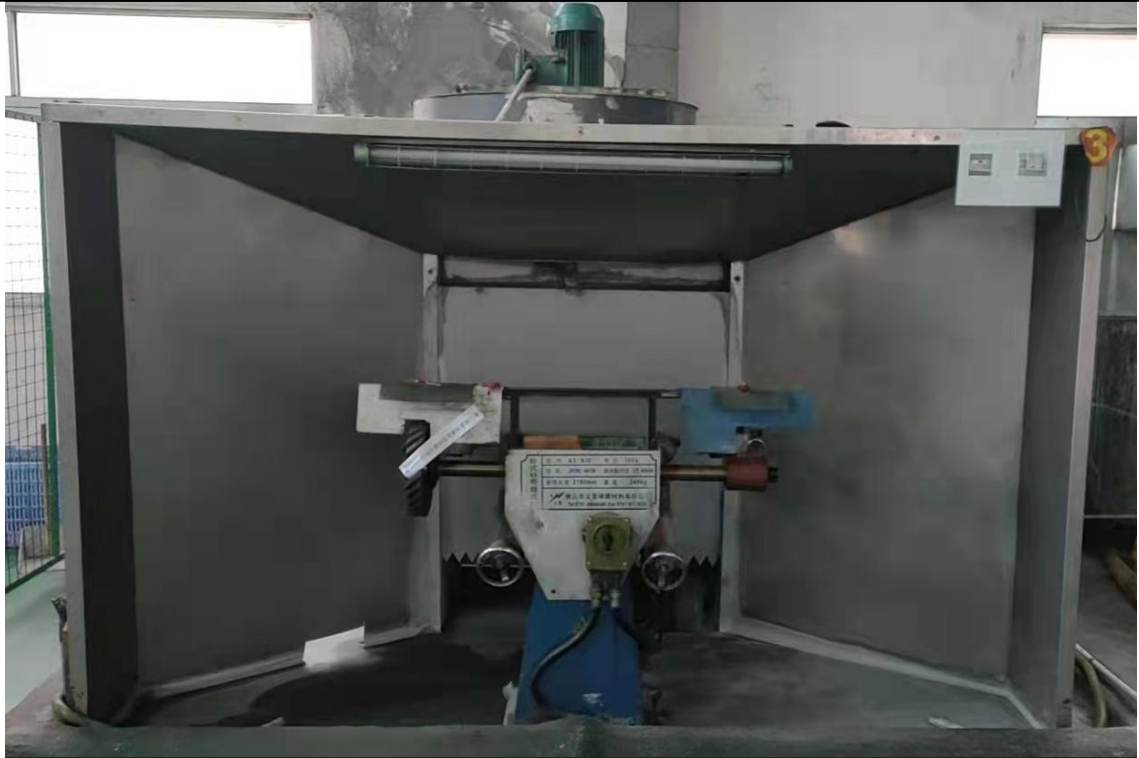
照片 4-1 抛光金属粉尘收集示意图
