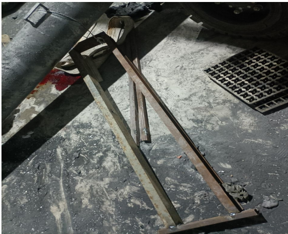
图三：涉事铁质支架及铁管概貌，支架用于支撑“绞龙”，铁管用于连接“绞龙”跟支架
