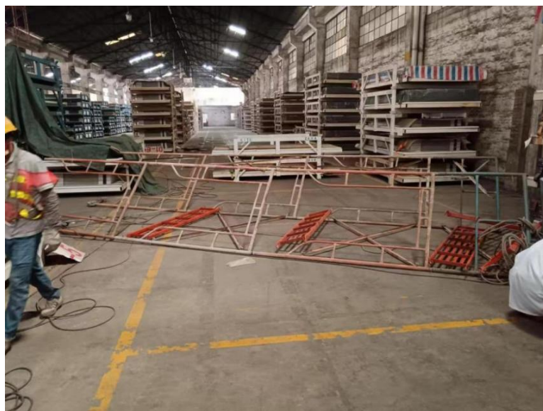
图二：事发现场概貌（二），图示倾倒的移动式操作平台为涉事移动式操作平台。
