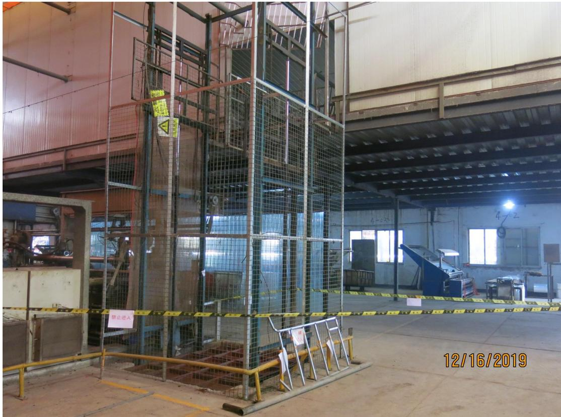
事故现场为信杭发公司定型车间 1 号升降平台，该升降平台高约 6 米，平台上部留有四条断裂的钢丝绳，平台台板为一块面积约 4 平方米的钢板，钢板呈翻转状态，平台旁张贴有安全操作规程，护栏挂有“货梯禁止载人”的警示标识，该平台限载 1000 公斤，二楼仓库出入口布置有钢结构护栏。
